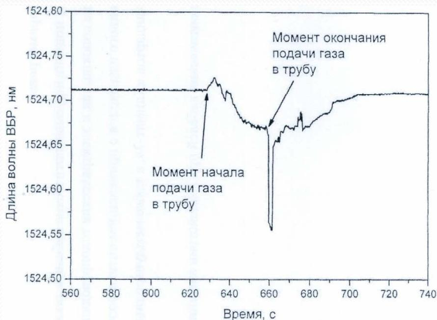
Пример регистрации локального изменения температуры около отверстия в трубопроводе при закачке газа под давлением и имитации утечки из газопровода.
