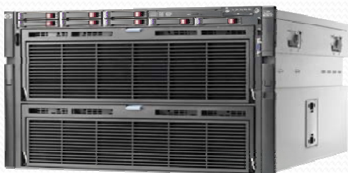
Сервер с общей памятью 8 процессоров Intel Xeon X7560 2 Тбайт оперативной памяти
