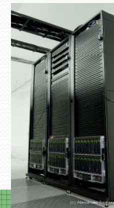
Кластер ИВЦ НГУ 96xBL220cG7+96xBL220cG6 + 64xBL460c Производительность 26,7 Тфлопс
