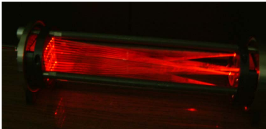
Многоходовая кювета С.М. Чернина с полной длиной оптического пути 39 м.
