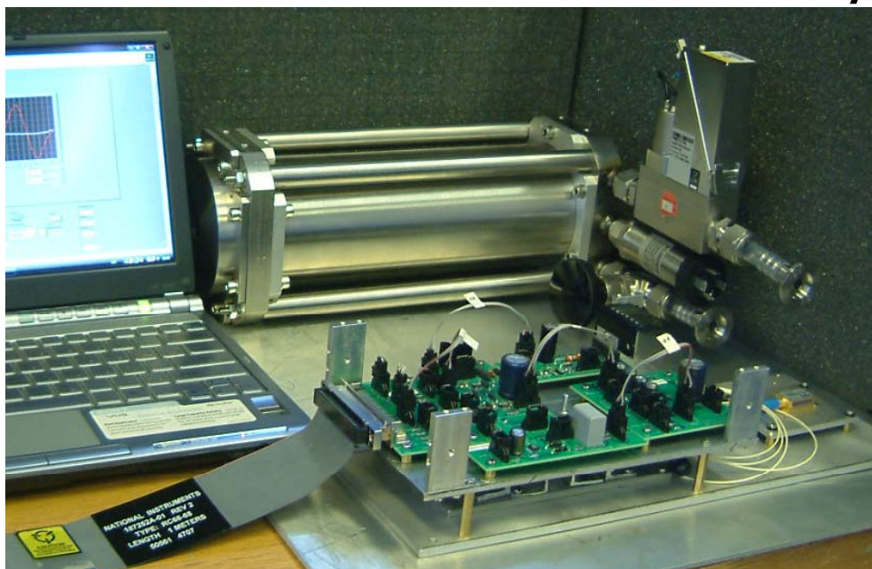
Внешний вид и блок-схема экспериментальной установки для скрининговой диагностики \text{CH}_4 , \text{CO}_2 и \text{H}_2\text{S}
